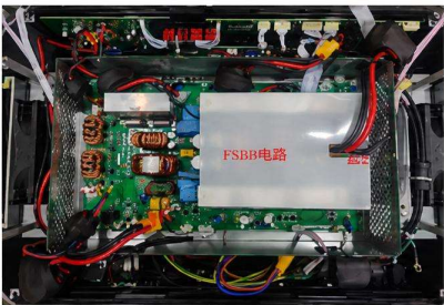
(a) 一体化样机装配
