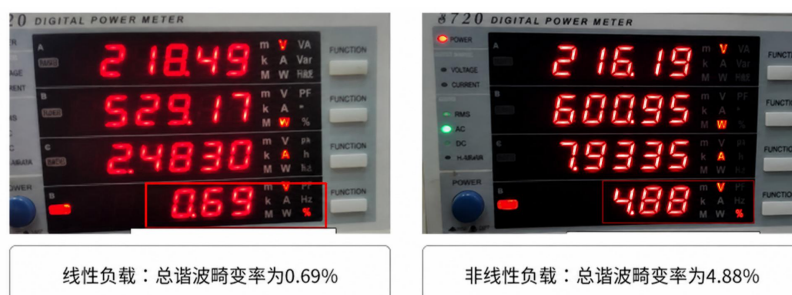
图 6 线性与非线性负载下输出电压 THD 实测
