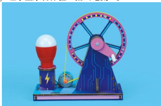
图2 手摇发电机图
